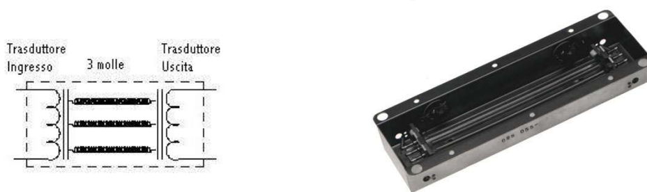
Fig. 2.3. Riverbero a molla. Alla sinistra è visibile lo schema di principio con i due trasduttori (trasformatori) e le molle (in questo caso 3). A destra una foto di un vero riverbero a molla nella sua realizzazione fisica. Le molle sono visibili al centro della scatola metallica. A seconda del modello (quello in figura è un Accutronics® "Type 8), il tempo di riverberazione poteva variare da 1.2 fino a 4 secondi.
