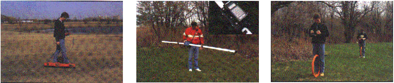
Fig. 2: da sx a dx: modelli EM38, EM31 e EM34-3 di Geonics (Toronto, Canada).
