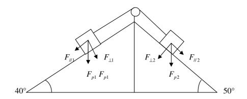
Il filo trasmette l'azione della forza di trascinamento  $F_{//2}$  lungo la stessa direzione della componente attiva  $F_{//1}$  pertanto esse saranno responsabili del moto del sistema. Prendiamo come positivo il verso di  $F_{//1}$ .
