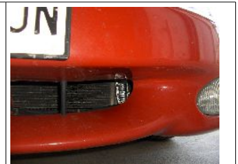
Presa d'aria accanto radiatore
