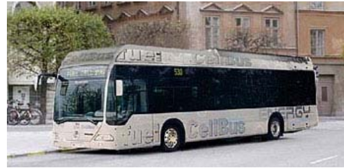
Citaro Bus Potenza: 250 kW Autonomia: 300 km Velocità max: 80 km/h
