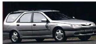
Renault FEVER (1998) Potenza celle: 30 kW Autonomia: 500 km Velocità max: 90 km/h
