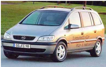
Opel Zafira Potenza celle: 50 kW (2 stack) Autonomia: 400-500 km Velocità max: 120 km/h
