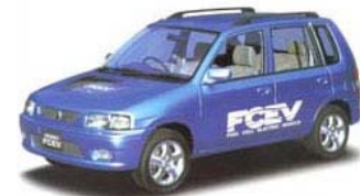
Mazda Demio FC-EV Potenza totale: 40 kW (celle 20 kW) (4 stack da 5 kW) Autonomia: 170 km Velocità max: 90 km/h
