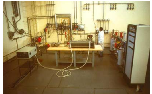
Stazione prova stack PEFC fino a 15 kW (ENEA, laboratori Casaccia)
