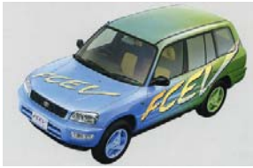
Toyota RAV-4 (1997) Potenza 20 kW Combustibile: metanolo Autonomia: 500 km Velocità max: > 125 km/h
