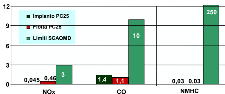
Emissioni impianti PC25 confrontati con i limiti emessi dal SCAQMD (ppm v , 15% O 2 secco)
