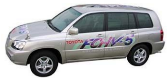
Toyota FCHV-5 (settembre 2001) Potenza: 90 kW Combustibile: idrogeno da reformer
