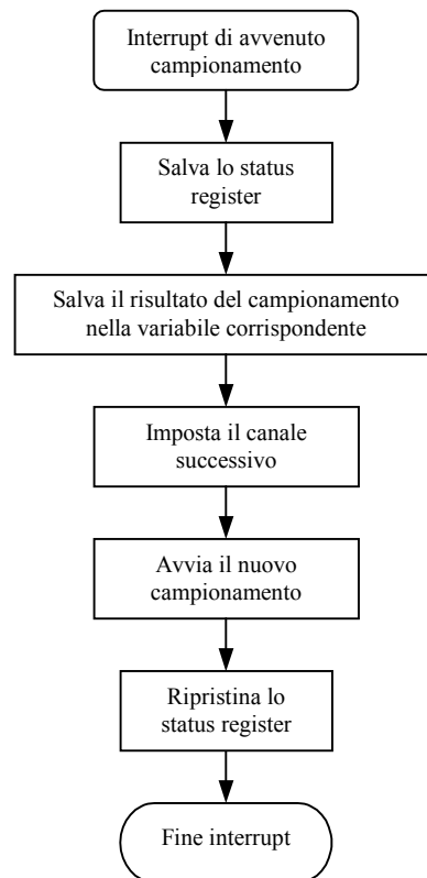
Figura 49: routine di interrupt per il campionamento dei segnali
