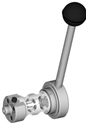
Figura 36: modello tridimensionale delle masse rotanti
