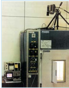
Sistema videoterigrafico e camera climatica.
