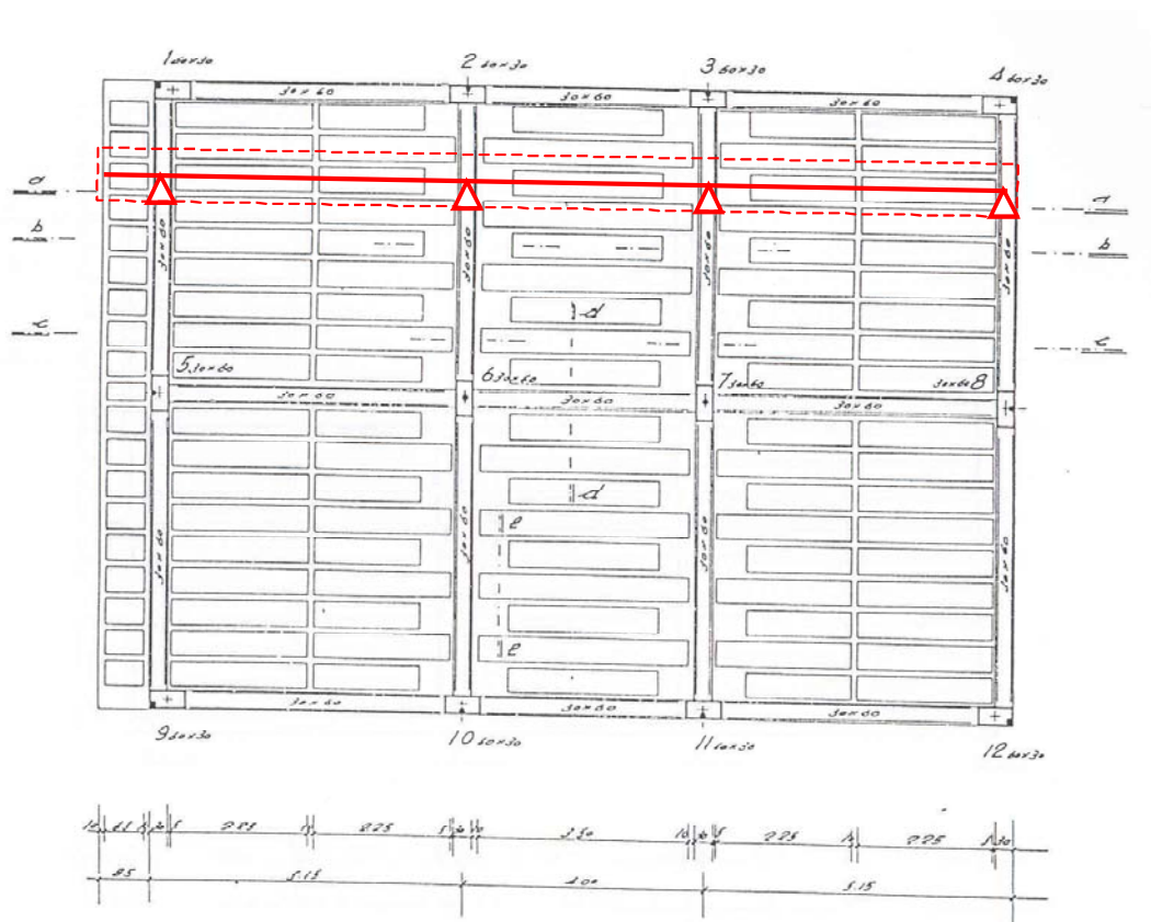
Figura 1.6: Esempio di deformata cilindrica del solaio
